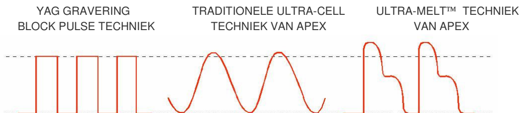
Afbeelding 1: Lasergolven bij drie graveermethoden
