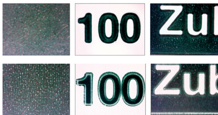
Oben: Ein mit der Dosierwalze UniFlex L erstelltes Muster. Unten: Ein mit einer Rasterwalze (180 L/cm, Vol. 12 cm 3 /m 2 ) erstelltes Muster.
