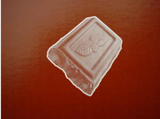
Afbeelding: Chocoladedruk, voltinten en 26 L/cm raster op één drukplaat
