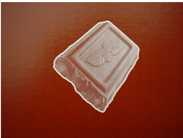
Afbeelding: Chocolade, B-golf, wit gestreken, volvlak en 26 L/cm raster op één drukplaat
