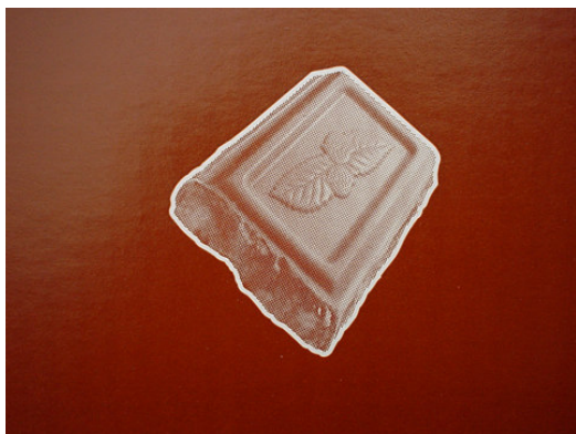
Image: Impression Chocolat, aplat et trame 26 l/cm sur un seul cliché.
