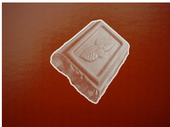
Imagen: Impresión Chocolate, Canal B, estucado, sólidos y tramados hasta 26 L/cm en la misma plancha
